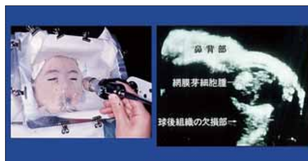
図4 試作した眼科用超音波断層検査装置とその網膜芽細胞腫の超音波断層像
