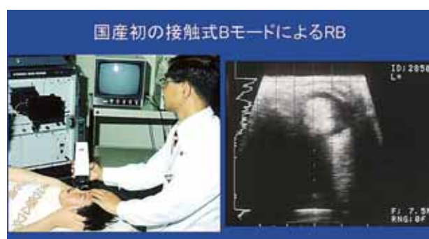
図5 国産の Bronson 型眼科用超音波断層装置とその画像
